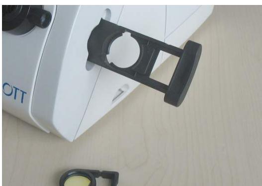
Die KL 1500 compact verfügt über einen Filterschieber (5), der mit einem Einlegefilter aus dem Filterset (als Zubehör erhältlich) bestückt werden kann.
