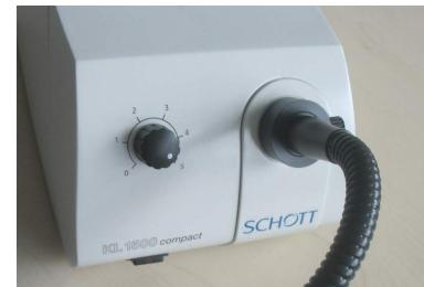
Tout d'abord tourner la vis de fixation (3) de la connexion (2) dans le sens contraire des aiguilles d'une montre. Poussez le conducteur de lumière jusqu'à la butée et tourner la vis de fixation dans le sens des aiguilles d'une montre pour fermer.
