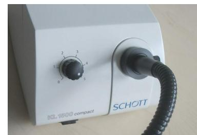
Zunächst die Feststellschraube (3) der Lichtleiteraufnahme (2) öffnen, durch Drehen gegen den Uhrzeigersinn. Den Lichtleiter bis zum Anschlag einschieben und Feststellschraube durch Drehen im Uhrzeigersinn schließen.
