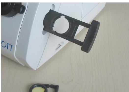
La KL 1500 compact dispose d'un tiroir porte filtre (5) qui peut être équipé d'un filtre d'insertion (disponible en tant qu'accessoire).
