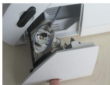
Eteignez tout d'abord la source de lumière. Ouvrez le compartiment à lampe (7) en tirant sur l'encoche prévue jusqu'à la butée. Enlevez la lampe, avec douille incluse, de sa fixation. Sortez doucement la lampe défectueuse de sa douille et placer une lampe neuve dans la douille (utilisez une lampe spécifiée sous point 6.4). Ensuite pousser la lampe dans la fixation jusqu'à la butée (enclenchement perceptible). Branchez la prise et reallumez la source de lumière.
